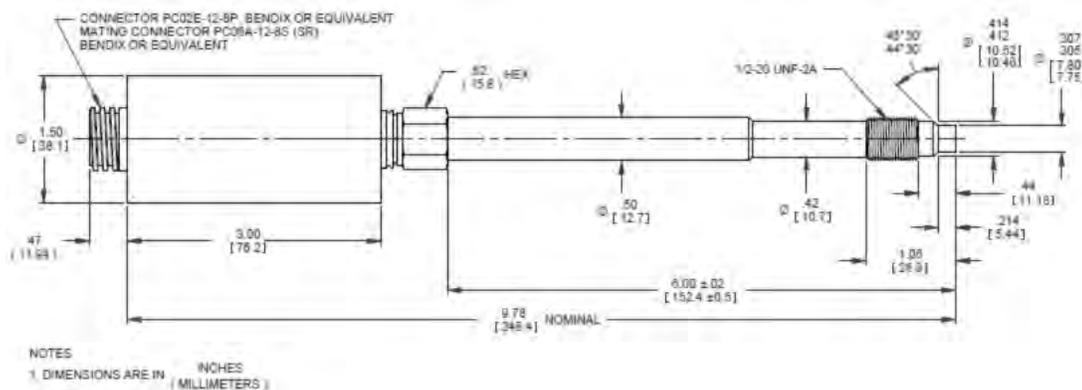
Beispiel: MDA 420 Abmessungen. Andere Produktabbildungen sind nach Produktmodell sortiert auf [www.Dynisco.com](http://www.Dynisco.com) verfügbar.
