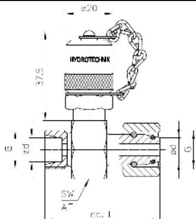
Für lötlose Rohrverschraubung nach DIN 2353
