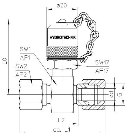
Für lötlose Rohrverschraubung nach DIN 2353
