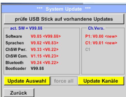
Ist das ILD 450 korrekt mit dem USB-Stick verbunden und es gibt neue Versionen der einzelnen SW Parts, werden diese in roter Schrift gekennzeichnet.
