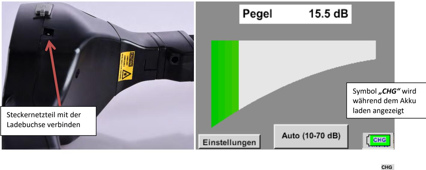
Das ILD 450 überprüft den Ladezustand des Akkus und startet den Ladevorgang gegebenenfalls automatisch.
