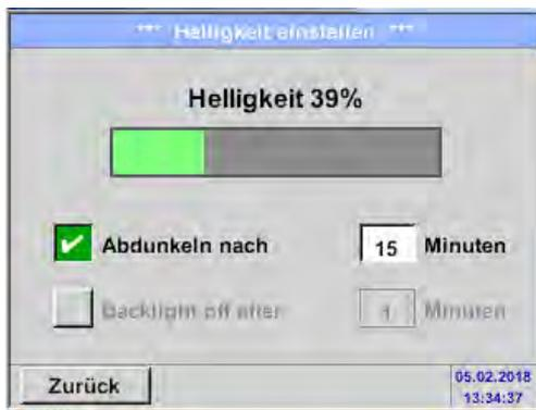
Mit Hilfe der *Abdunkeln-nach*-Taste kann, nach Ablauf eines zu definierenden Zeitintervalls (hier nach 15 Minuten), die *Helligkeit* auf das Minimum herabgesetzt werden.
