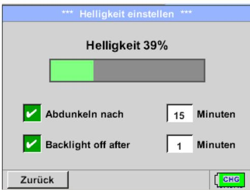
Um den Energieverbrauch zu reduzieren (Geräteaufzeit) kann durch Setzen von „Backlight off after“ die Display-Hintergrundbeleuchtung ausgeschaltet werden.
