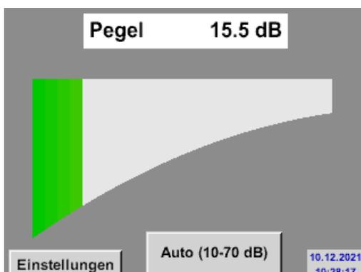
Nach dem Einschalten des ILD 450 erfolgt die Initialisierung und wechselt danach in Leckage Anzeige
