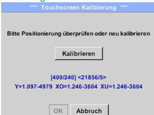
Falls nötig, kann hier eine Touchpanel-Kalibrierung durchgeführt werden.
