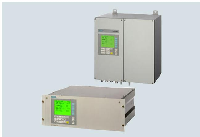
Die Gasanalysengeräte ULTRAMAT 6, Ein- oder Zweikanal, arbeiten nach dem NDIR-Zweistrahl-Gegentaktverfahren und messen hochselektiv Gase, deren Absorptionsbanden im Infrarot-Wellenlängenbereich von 2 bis 9  $\mu\text{m}$  liegen, wie z. B. CO, CO<sub>2</sub>, NO, SO<sub>2</sub>, NH<sub>3</sub>, H<sub>2</sub>O sowie CH<sub>4</sub> und weitere Kohlenwasserstoffe.
