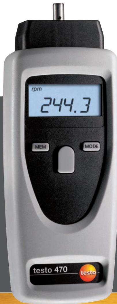
Das mit einer Hand bedienbare Drehzahl-Messgerät testo 470 bietet eine optimale Kombination aus optischer und mechanischer Drehzahl-Messung. Durch einfaches Aufstecken eines Adapters für eine Tastspitze oder ein Laufrad wird aus der optischen eine mechanische Messung. Dadurch können zusätzlich Geschwindigkeiten und Längen gemessen werden.
