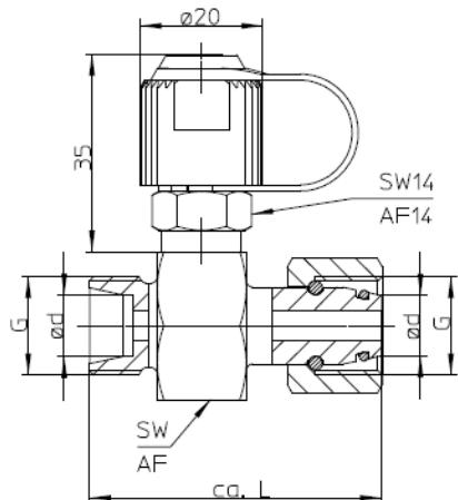
Für lötlose Rohrverschraubung nach DIN 2353
