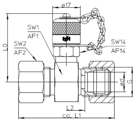
Für lötlose Rohrverschraubung nach DIN 2353
